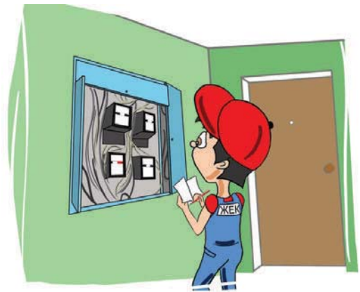
Рисунок 4.11 Зняття показників електричного будинкового приладу обліку
